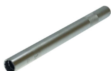
Nasadka 14 mm x 250 mm napęd 3/8" do świec zapłonowych
