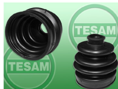
Osłona gumowa przegubu półosi uniwersalna 23 - 70 mm
